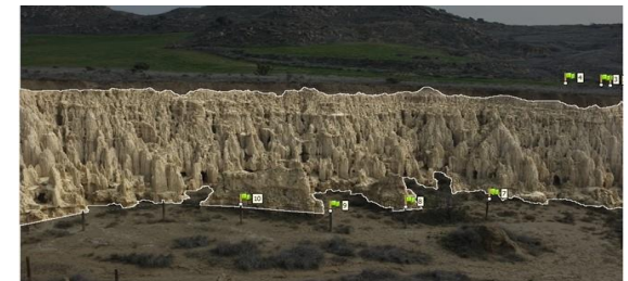
Fig 7. Imagen digital del área de estudio con máscara y puntos de control para el análisis fotogramético (Agisoft Photoscan)
