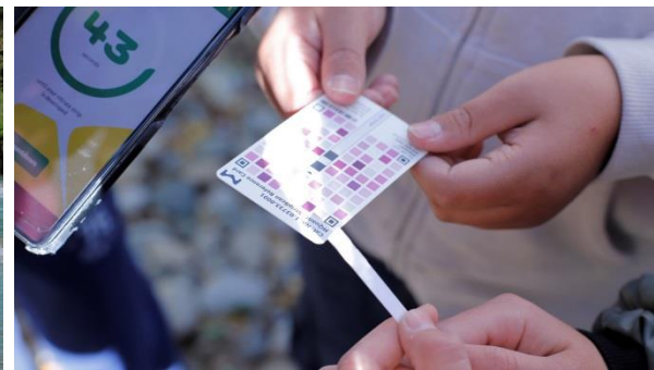
Este es el kit básico para analizar el nivel de nitratos del agua. La información se recoge en una app que centraliza los datos llamada CitMApp
