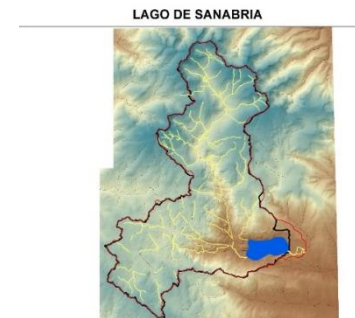
Fig 1. Delimitación cuenca hidrográfica a partir del Modelo Digital del Terreno de alta resolución elaborado con ficheros lidar ( http://www.ign.es )
