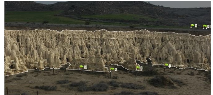
Fig 7. Imagen digital del área de estudio con máscara y puntos de control para el análisis fotogramétrico (Agisoft Photoscan)
